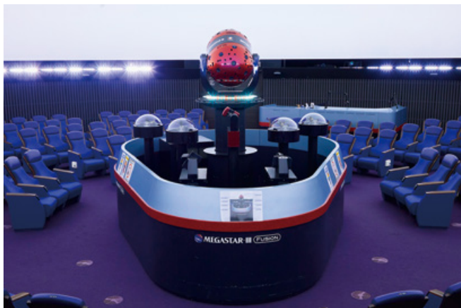
かわさき宙と緑の科学館プラネタリウムの投影機ユニット。赤い楕円体の恒星投影機を囲んで、透明な半ドーム状の惑星投影機が並びます。
